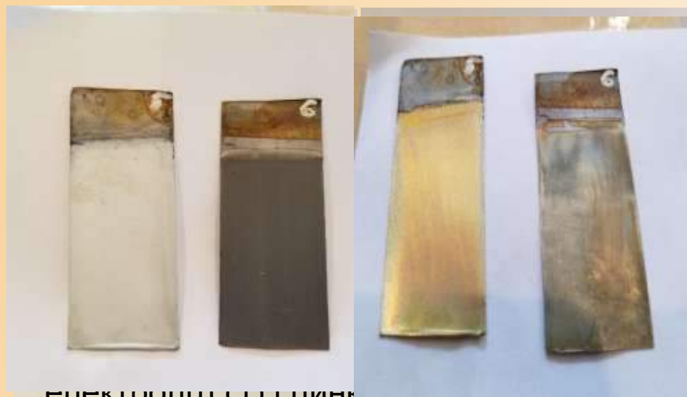
Зразки у простому сульфатному електроліті ( i = 0,5 \text{ A/дм}^2 ) і цинкатному (6) при i = 3 \text{ A/дм}^2
