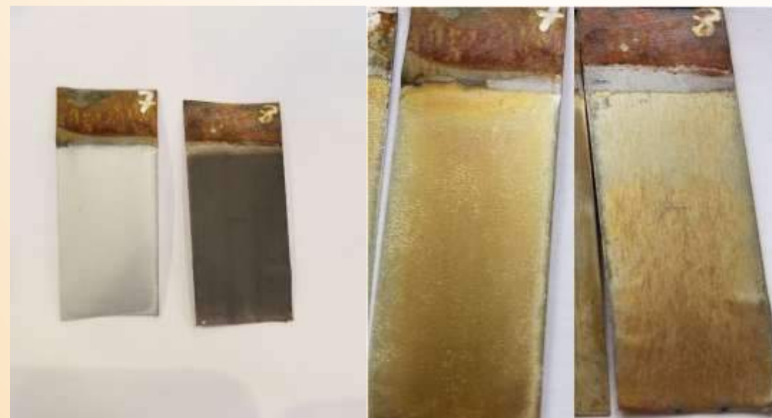
Зразки у простому сульфатному електроліті ( i = 1 \text{ A/дм}^2 ) і цинкатному (8) при i = 5 \text{ A/дм}^2
